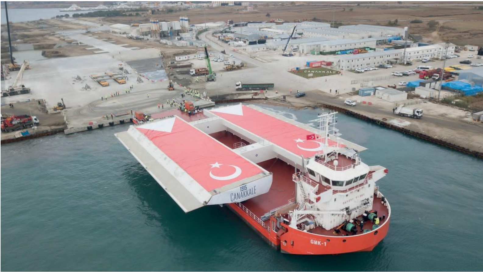
1915 Çanakkale Köprüsü Tabliyelerinin Taşınması Projesi
